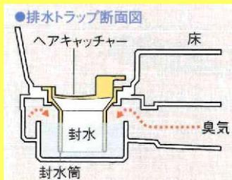
封水とは…浴室やトイレ、洗面などの排水パイプのU字やS字型となっているところで水を溜めて、パイプを伝わってくる臭気を防いでいます。この水を封水といいます。この封水が溜まっていないと、排水管内の臭気が上がってきます。
